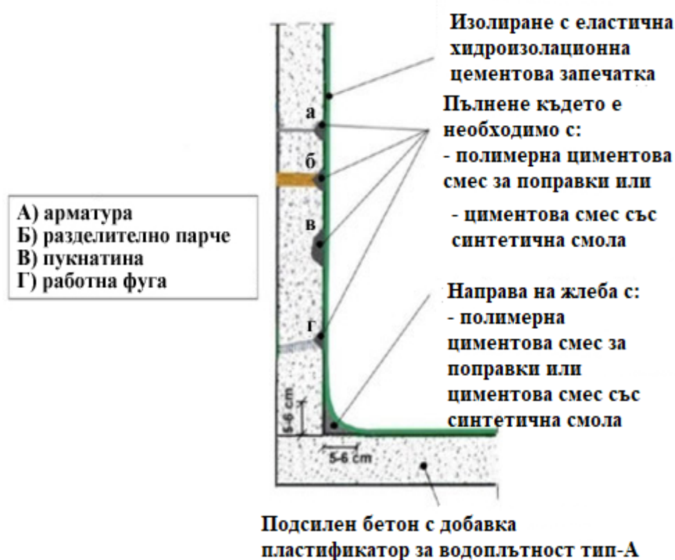
Фиг. 5. Детайлна подготовка на основата и осигуряване на въздухонепроницаемост на пневмо-кесонна конструкция
