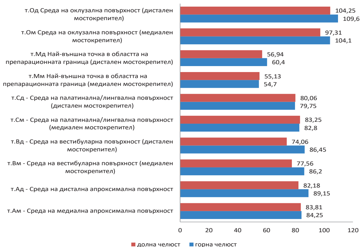
Фиг. 5. Сравнителен анализ на средните стойности на отстоянието, измерено чрез силиконова проба с CAD софтуер при изработените по КОТ конструкции според вида на протезираната челюст (μm)
